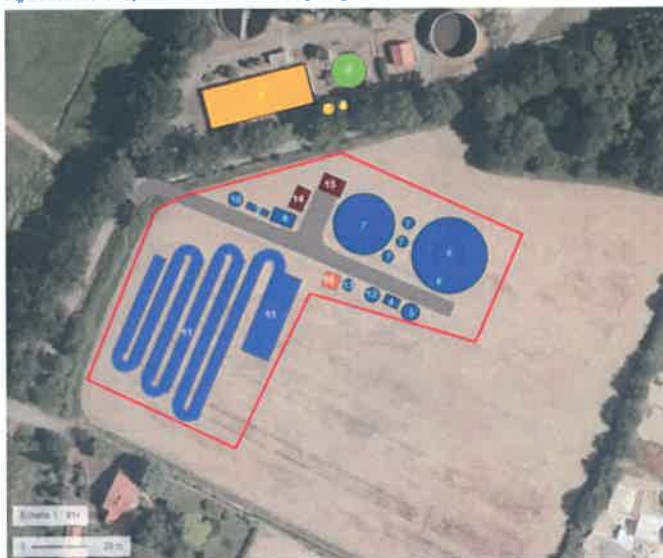
Figure 68 : Plan d'implantation 2 avec zone de rejet végétalisée
